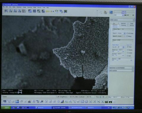
А в лаборатории термообработки и физики металлов нам показали растровый электронный микроскоп, который примерно в 500 раз превышает предел увеличения оптических микроскопов. Под микроскопом нам удалось рассмотреть углеродные нанотрубки, диаметр которых составляет всего лишь 6 нм! Углеродные нанотрубки используют в различных областях науки и техники. Например, они являются датчиком для обнаружения молекул в газовой среде, поэтому могут использоваться при изготовлении газовых извещателей.
